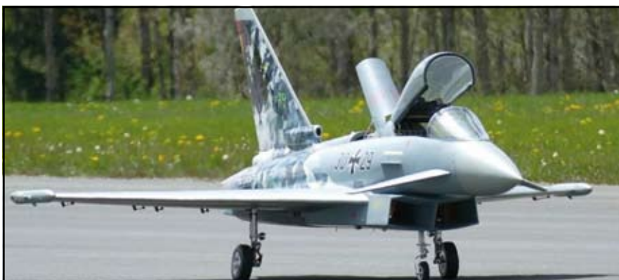
Eurofighter im Maßstab 1 : 3,7; Gewicht 82 kg; Rumpflänge 4,30 m; Spannweite 2,96 m. Antrieb 2 Frank-Turbinen mit je 30 kg Schub. Foto: Thomas Roth
