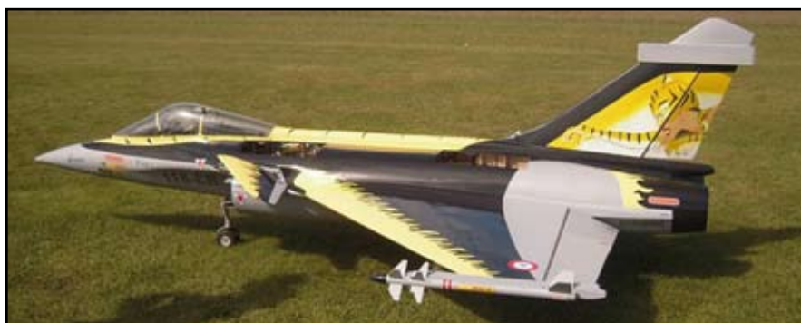
Die Dassault Rafale ist ein zweistrahliges Mehrzweckkampfflugzeug. Maßstab 1 : 3,5; Gewicht 46 kg; Rumpflänge 4,30 m; Spannweite 3,20 m; Antrieb: 2 Frank-Turbinen. Foto: Thomas Roth
