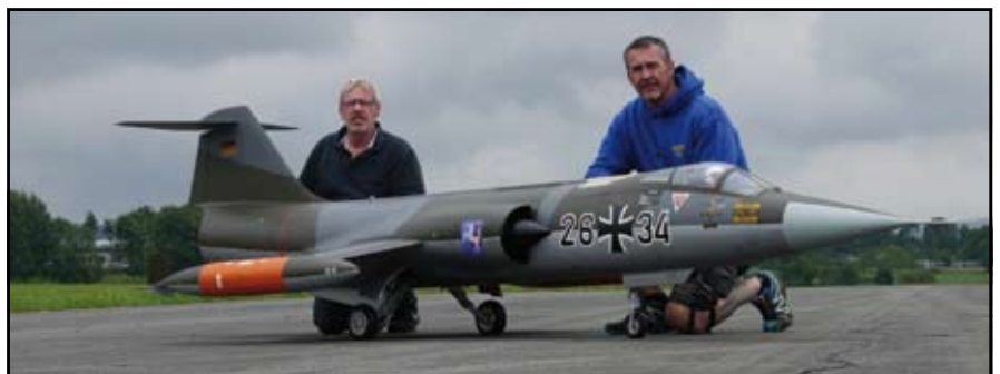
Thomas Roth (links) und Heiko Graf (rechts). Starfighter F-104 im Maßstab 1 : 4; Gewicht 32 kg; Rumpflänge 4,20 m; Spannweite 1,70 m. Foto: Thomas Roth
